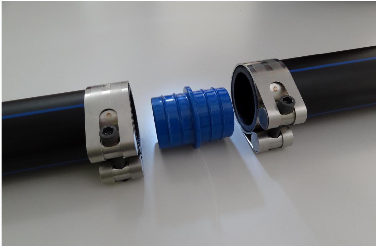
**STRAUB-PLAST-PRO** - Axial zugfestes Komplettsystem für die schnelle und einfache Verbindung von Druckrohren aus Polyethylen (PE) in der Dimensionierung SDR 11 (63.0 mm – 110.0 mm, PN16) und SDR 17 (>110.0 mm – 355.0 mm, PN10) für die Verwendung in der Wasserversorgung, Druckentwässerung, Industrie und im Deponiebau.
